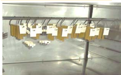
恒温槽による加速劣化試験
