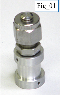
0.80mL_耐圧容器 最40MPa/400°C 材質：SUS316
