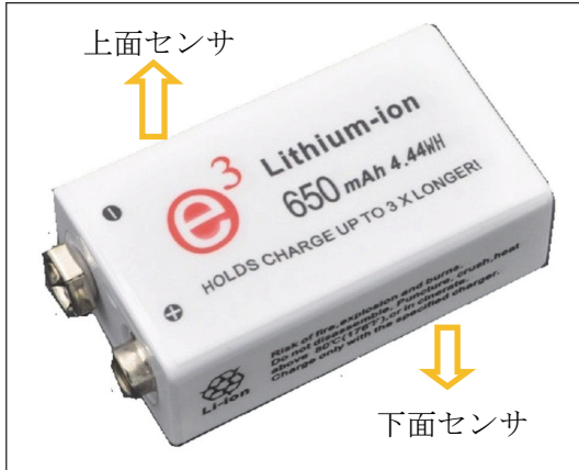
Fig-01: 006P_7.4V_2600mAh 0.1CC 充電プロセスの電圧変化と熱流測定
