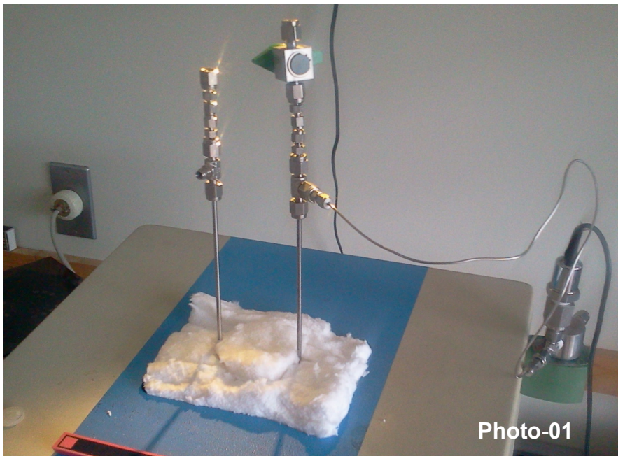
Photo-01：右側が測定サンプル側耐圧容器の上部配管部、左が基準サンプル側の上部配管部。Tユニオンで分岐された1/16インチSUS配管が圧力センサーと電磁リリーフバルブに連結されています。
