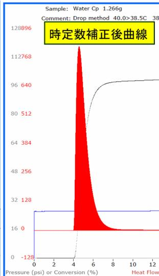
Mini-CRCには時定数補正用の校正ヒータが装備されていませんが、スパイク法による時定数補正ができます。Mini-CRCを使って比熱容量測定する場合、ドロップ方式(落下式熱量計の手法)を使います。この測定手法は時定数補正のスパイク方式の測定手法とほぼ同じです。Mini-CRCに付属するWinCRCソフトウェアのDynamic Correction機能を使って、測定データ01のオリジナル曲線のピークが一番早く、ベースラインに戻る1次のパラメータを検索します。サンプルの水が1.266g充填されている状態で $\tau 1=1.25\text{min}$ 、 $\tau 2=0.50\text{min}$ と求まりました。
