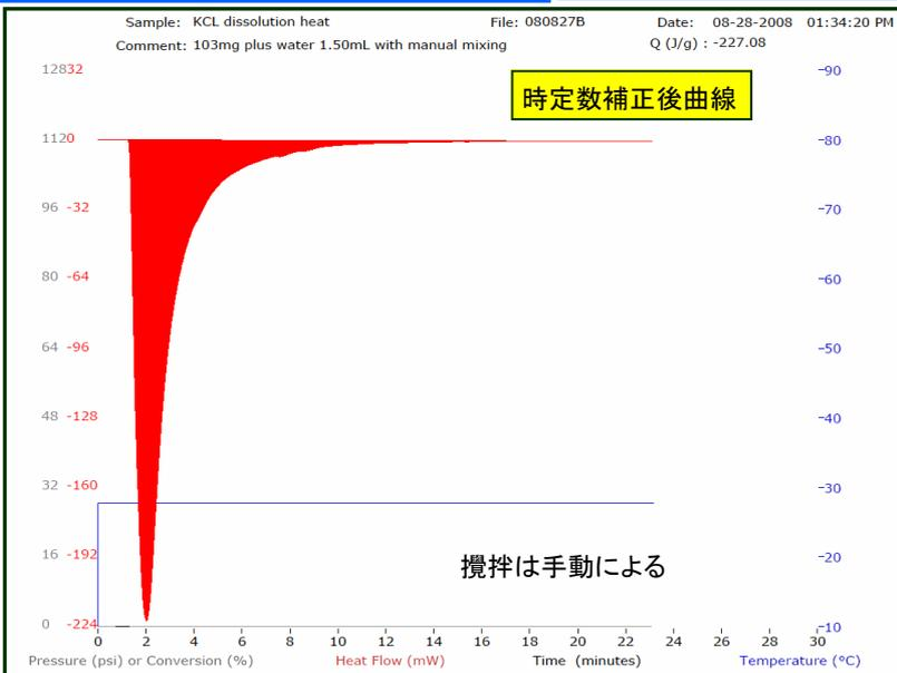
Mini-CRCの溶解熱測定によるバリデーシンの例です。この測定データはスパイク法で求めた時定数補正值( $\tau 1=1.25\text{min}$ 、 $\tau 2=0.50\text{min}$ )を使って時定数補正した測定データです。高速型SuperCRCeによる測定データよりもピークがシャープに測定されていることがわかります。このMini-CRCがSuperCRCと同じくマグネチック・スターラ機能や昇温制御機能や校正ヒータ内蔵などが加わると、SuperCRCを超える高性能小型反応熱量計になるのではないでしょうか？
