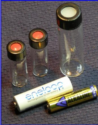
SuperCRCの姉妹機であるMini-CRCは15mLバイアルに代えて、4mLバイアルを使用する小型反応熱量計です。炉制御機能やマグネチック攪拌機能がなく、測定用途は限定されます。しかし利点として検出器が小さくなる分、時定数が小さく、高速型SuperCRCeよりも応答感度が優れています。左写真の赤色セプタムのバイアルがMini-CRC用4mLバイアルです。単4電池より一回り、大きいサイズです。
