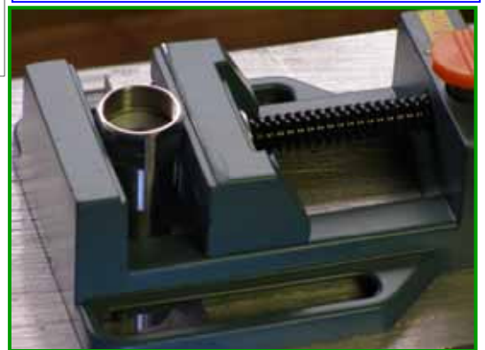
容器の円筒面に傷をつけないことが重要です。容器上端部で固定するので安心です。
