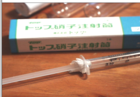
写真-2: プランジャー先端部にテフロンシールテープを巻きつけ、シリンジに挿入する。
