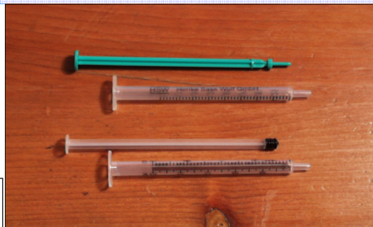
写真-1: プランジャーを抜き取ったトップ社製ディスポ・シリンジ。プランジャー先端部の黒い部分にブタジエンゴムが使われている(下)、HSW社製(上)はゴムが使われていない。
