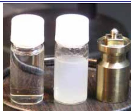
市販mg-スケールDSCの検出感度はおよそ1μWレベルです。pDSCの検出感度は0.2mWなのでmg-DSCの1/200の検出感度です。しかしpDSCはmg-DSCと比較して測定試料量が100倍あるので、容器から発生する熱量は100倍大きくなります。
